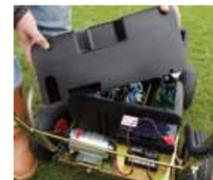
La cubierta extraíble proporciona protección y facilita el acceso al sistema eléctrico.
