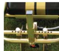
Espaciadores de disco pre-taladrados para facilitar los cambios rápidos de anchura de las líneas y barra guardabarros delantera que protege el conjunto de boquillas.
