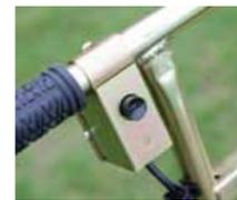
Sencillo botón de encendido y apagado que permite un control instantáneo de la aplicación de la pintura.
