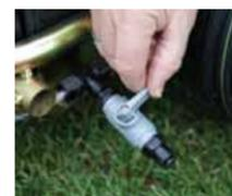
Palanca de 'lavado' de fácil acceso que permite la extracción de pintura y la limpieza de los tubos.
